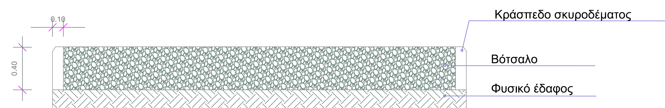
Λ7. ΤΥΠΙΚΗ ΔΙΑΤΟΜΗ ΒΟΤΣΑΛΟΥ ΓΙΑ ΤΗΝ ΠΕΡΙΟΧΗ ΤΟΥ ΟΡΓΑΝΟΥ ΑΝΑΡΡΙΧΗΣΗΣ κλ. 1:20
