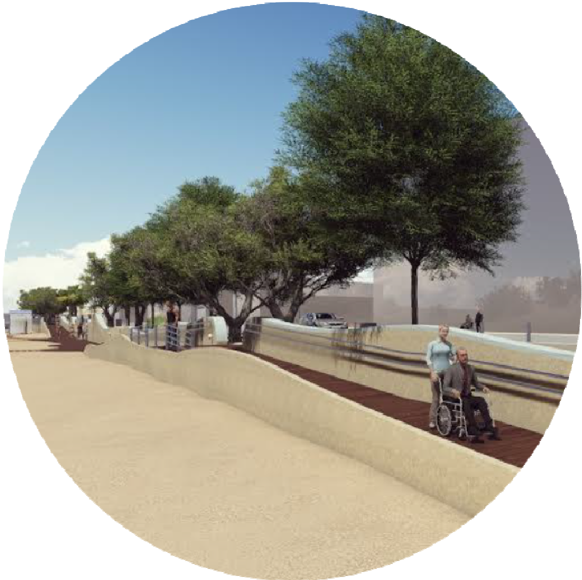
Κυματόμορφο τοιχείο με επίτοιχα φωτιστικά και διπλή ανοξείδωτη χειρολαβή
