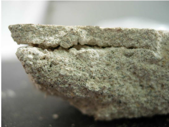
Εικόνα 3. Μακροσκοπική φωτογράφιση, πλάγια όψη. Αποκόλληση στρωμάτων επιχρίσματος.
