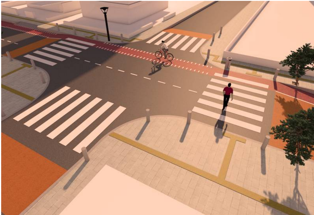
Εικόνα 10: Τρισδιάστατη απεικόνιση συμβολής της οδού Μονής Γωνιάς με την οδό Φούμηδων. (υπερυψωμένη διάβαση)
