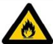
Εύφλεκτες ύλες ή/ και υψηλή θερμοκρασία
