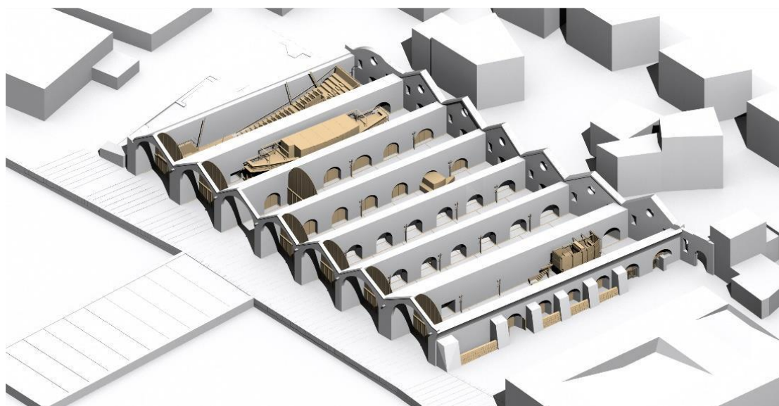
Εικόνα 6. Οι νέες κατασκευές εντός των θόλων σε συνάφεια με τους τοίχους.
